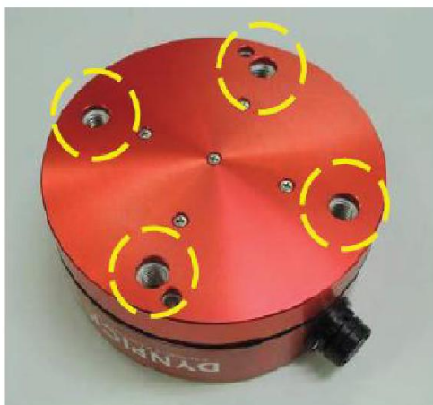
圖 2－2 至感測器的安裝
